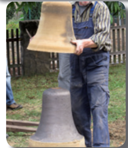
Die "falsche" Glocke wird entfernt. Sie hat ihre "Schuldigkeit" getan. Es ist noch deutlich zu erkennen wo sich die geschmolzene Verzierung und die Barbara-Plastik befanden.
