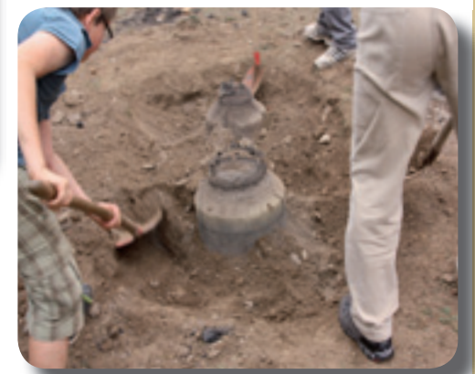
Die beiden Glocken werden am darauffolgenden Tag unter Mithilfe fleißiger Zuschauer freigelegt. Die Formen sind noch immer nicht ganz abgekühlt
