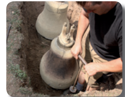
Dank der Unterstützung eines Baggerfahres vom städtischen Bauhof können die Glockformen sicher in die Grube heruntergelassen werden.
