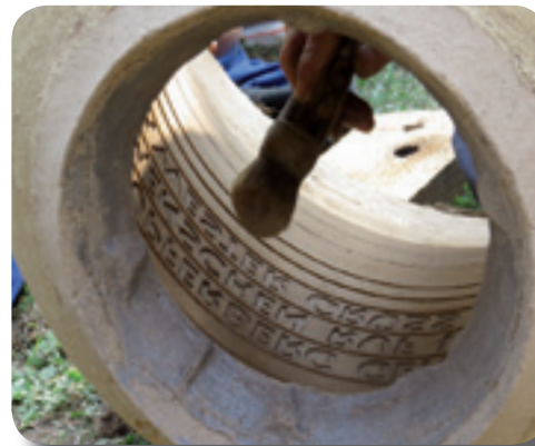
Mit dem Pinsel wird die Inschrift noch einmal von Fremdkörpern gereinigt.
