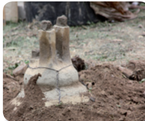
Die Dammgrube wird nach dem Einsetzen der Formen mit „Dammerde“ gefüllt. Dies verhindert das Zerspringen der Formen beim Gießen. Nur Eingußöffnung und Windpfeifen bleiben frei.
