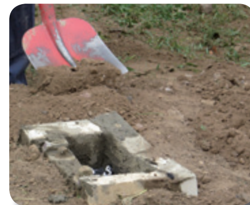
Die Dammgrube wird nach dem Einsetzen der Formen mit „Dammerde“ gefüllt. Dies verhindert das Zerspringen der Formen beim Gießen. Nur Eingußöffnung und Windpfeifen bleiben frei.
