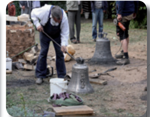
Immer mehr kommen die Glocken zum Vorschein. Die anwesenden Kinder beteiligen sich mit viel Eifer bei der Reinigung. Zuletzt werden die Glocken mit Sand auf Hochglanz poliert.
