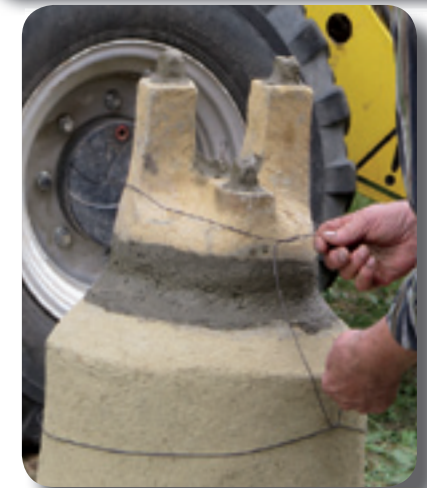
Windpfeife und Mantel werden mit Lehm und Draht verbunden. Für einen erfolgreichen Guss muss alles exakt passen.
