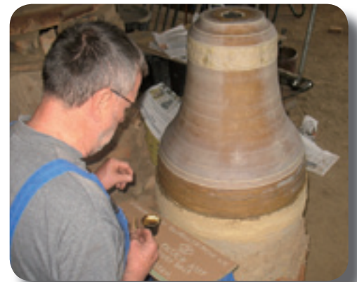
Befestigung von Verzierung und Inschrift. Jeder noch so kleine Fehler ist später auf der Glocke zu sehen.
