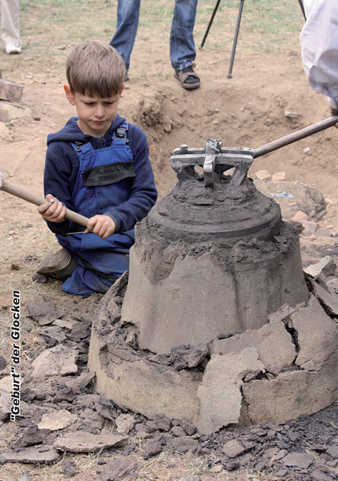
Mantel und Kern werden entfernt. Bald kommen die beiden Glocken zum Vorschein. Alle Zuschauer sind auf das Ergebnis gespannt.
