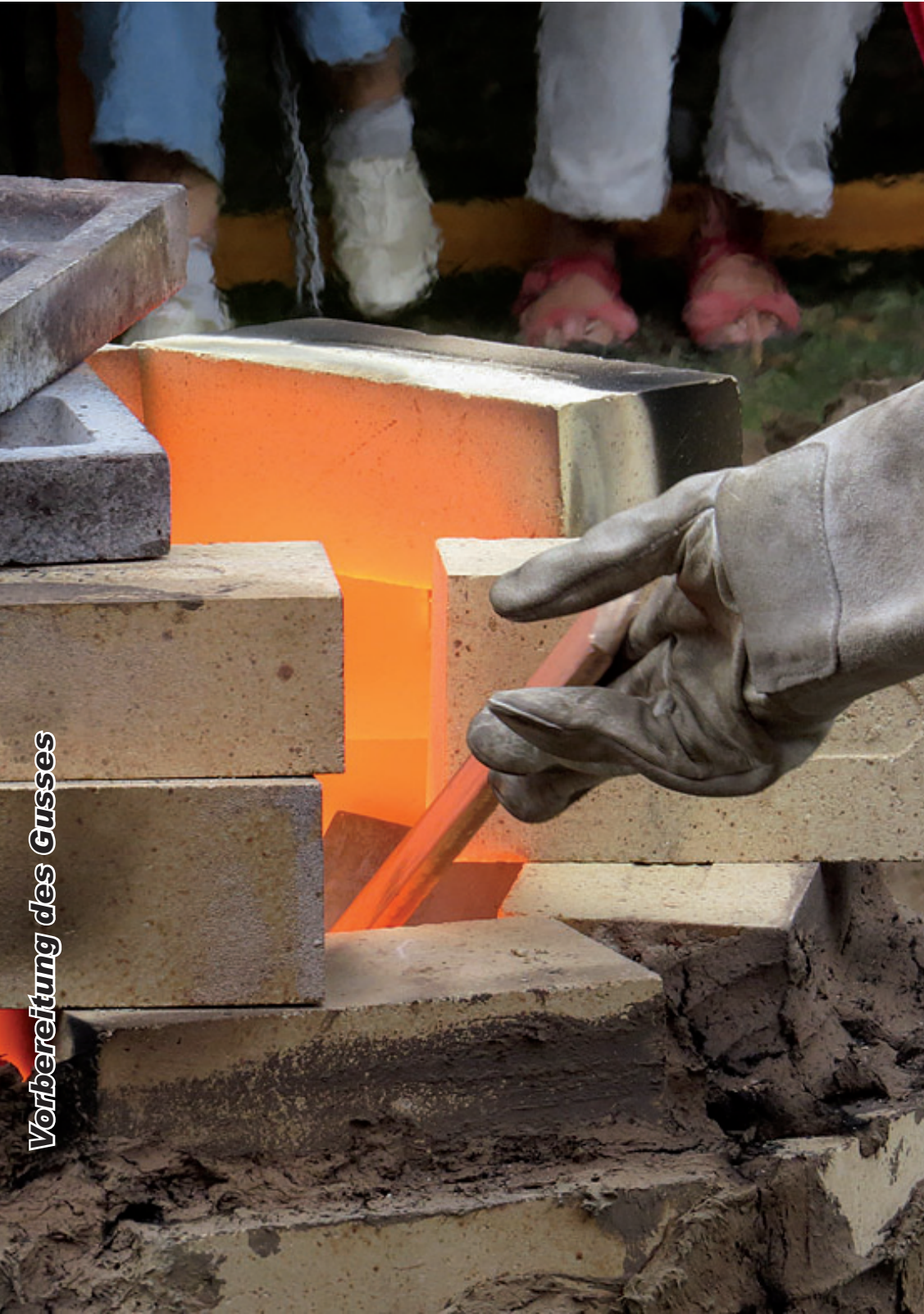
Die Dammgrube wird nach dem Einsetzen der Formen mit „Dammerde“ gefüllt. Dies verhindert das Zerspringen der Formen beim Gießen. Nur Eingußöffnung und Windpfeifen bleiben frei.
