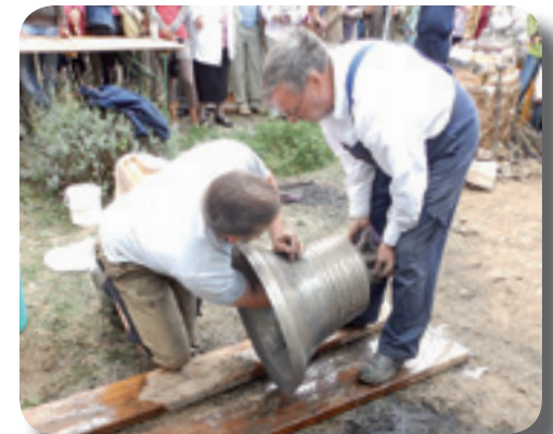
Immer mehr kommen die Glocken zum Vorschein. Die anwesenden Kinder beteiligen sich mit viel Eifer bei der Reinigung. Zuletzt werden die Glocken mit Sand auf Hochglanz poliert.
