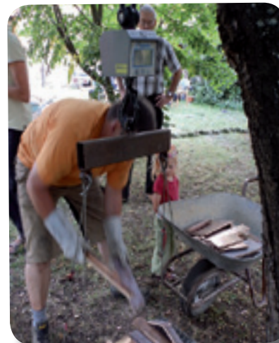
Das genaue Verhältnis von Kupfer (78%) und Zinn (22%) wird mit einer Waage ermittelt.
