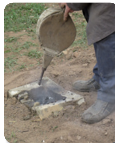
Die Dammgrube wird nach dem Einsetzen der Formen mit „Dammerde“ gefüllt. Dies verhindert das Zerspringen der Formen beim Gießen. Nur Eingußöffnung und Windpfeifen bleiben frei.
