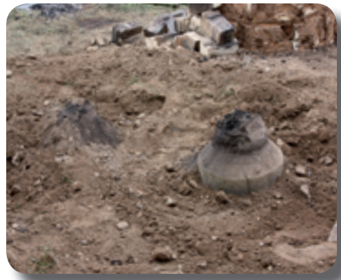
Die beiden Glocken werden am darauffolgenden Tag unter Mithilfe fleißiger Zuschauer freigelegt. Die Formen sind noch immer nicht ganz abgekühlt
