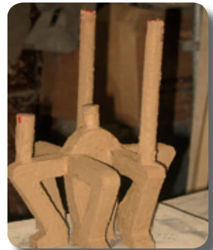
Befestigung von Verzierung und Inschrift. Jeder noch so kleine Fehler ist später auf der Glocke zu sehen.
