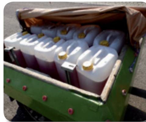
Das Heizöl zur Erwärmung der Bronze Legierung auf 1.300 Grad steht bereit.
